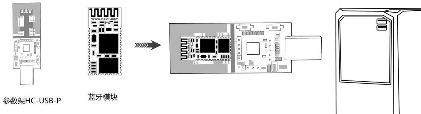
将蓝牙模块 HC-06 放入参数架 HC-USB-P 中 (如图), 直接插入 PC 的 USB 接口就可以对模块进行调试。
