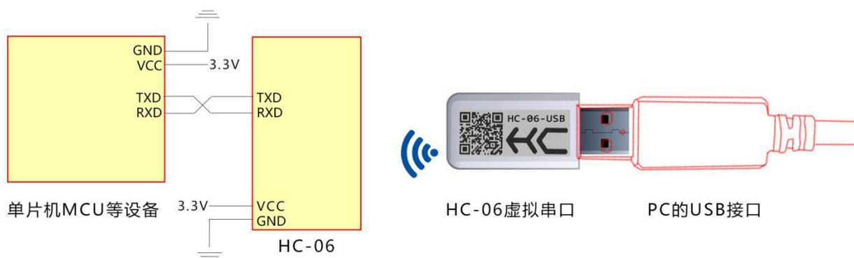
HC-06 直接连接电脑需借助 HC-06-USB 蓝牙虚拟串口与电脑相连。
