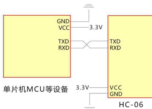
①：模块与供电系统为 3.3V 的 MCU 连接时，串口交叉连接即可（模块的 RX 接 MCU 的 TX、模块的 TX 接 MCU 的 RX）
