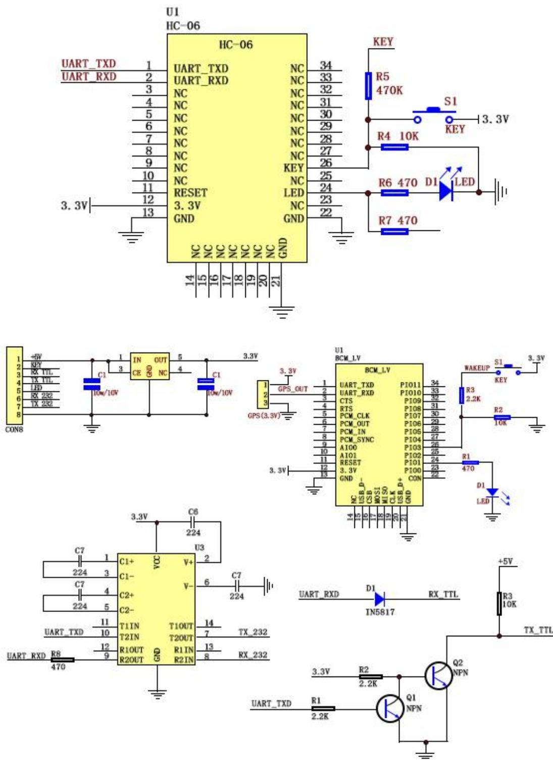
注：蓝牙模块的 PIN2 : UART-RXD 不带上拉，如果单片机 TXD 无上拉能力的话需要在模块的 UART-RXD 脚上接个上拉电阻，这个很容易被用户忽略。
