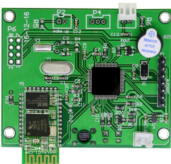
模块天线部分下面不能敷铜，不能走线，否则影响信号，建议天线部分底板挖空，天线尽量靠近板边
