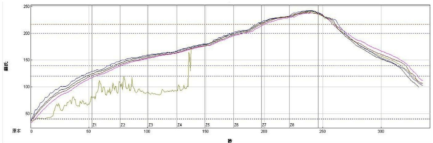
建议首次大批量贴片生产的厂家, 先过炉 20~30 片模块, 检查炉温是否合适.
